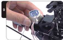
将陀螺仪固定好 Fix the gyro.
