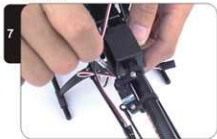
将方向舵机固定 Fix the rudder servo
