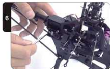
将螺距舵机固定 Fix the pitch servo
